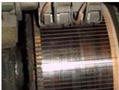
Fig. 1 – Effets de la présence de graisse (de roulements) sur une machine à collecteur
