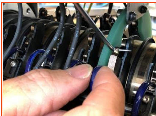
Outil permettant de lever les ressorts pour contrôler l'état des balais
